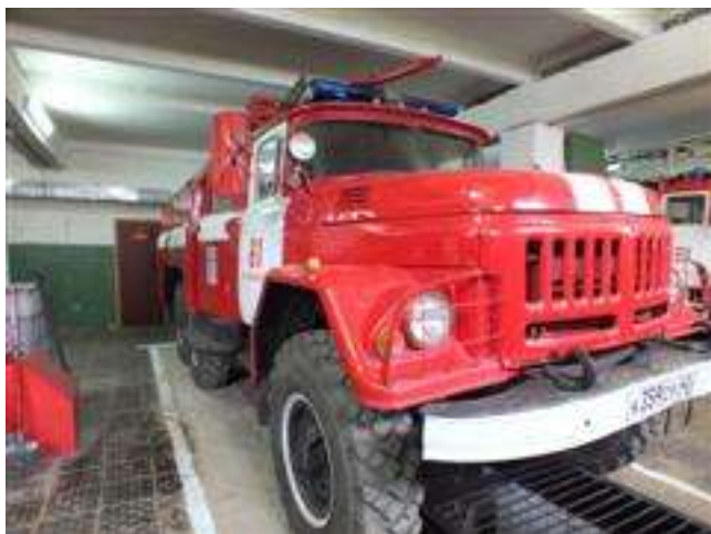
Специальный пожарный автомобиль АЦ-40 (131) автоцистерна на базе автомобиля ЗиЛ-131.
